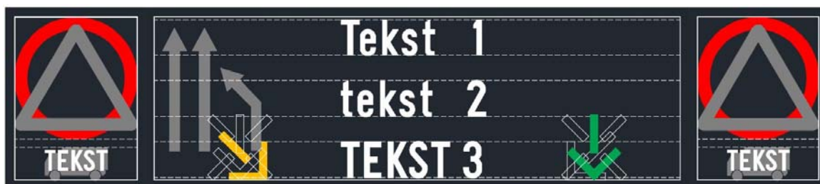
Slika : Shematski prikaz oblike spremenljivega prometnega znaka ZIZ2
